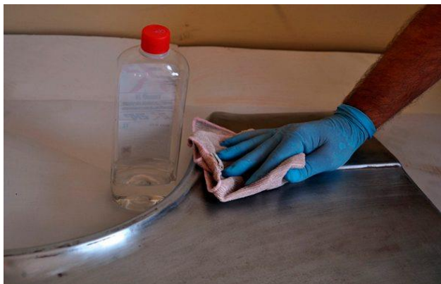
Рисунок 21 - Обезжиривание металла растворителем [11]
